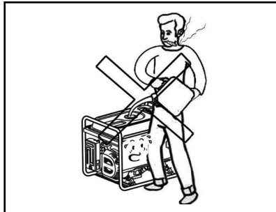
No fumar al recargar combustible.
